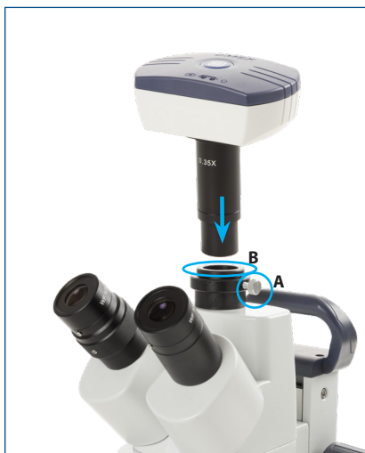
La tête trinoculaire EduBlue. Pour régler la hauteur de la caméra, desserrez la vis (A), puis tournez la partie supérieure (B) vers le haut ou vers le bas. Resserrer la vis
