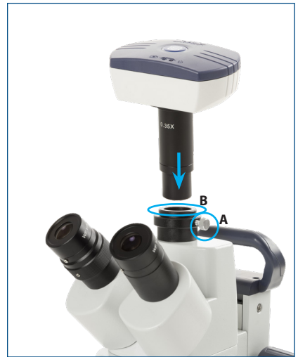
Der EduBlue Trinokularkopf. Um die Höhe der Kamera einzustellen, lösen Sie die Schraube (A) und drehen Sie dann den oberen Teil (B) nach oben oder unten. Ziehen Sie die Schraube wieder an
